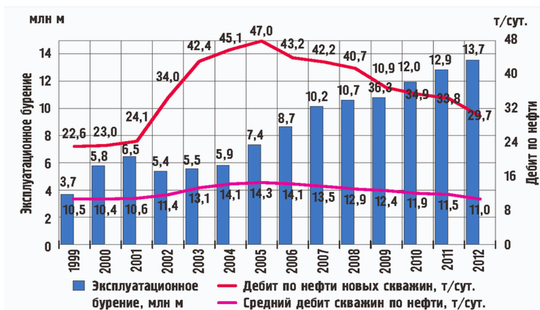
Рисунок 1 - Объемы эксплуатационного бурения и дебитов нефтяных скважин Ханты-Мансийского автономного округа (баженовская свита) в 1999-2012 гг.
